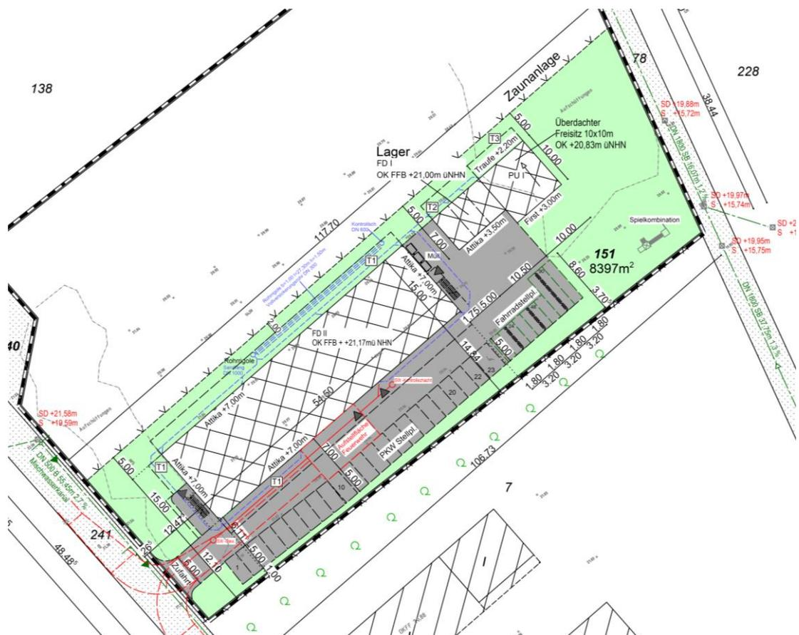
Abbildung 1: Ausschnitt Lageplan zum Bauvorhaben (INGENIEURBÜRO COENEN GMBH, Goch, 22.07.2024)
